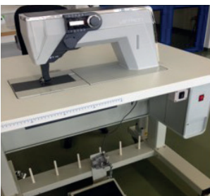
Ultraschallschweißtechnik für funktionale und dekorative Nähte
